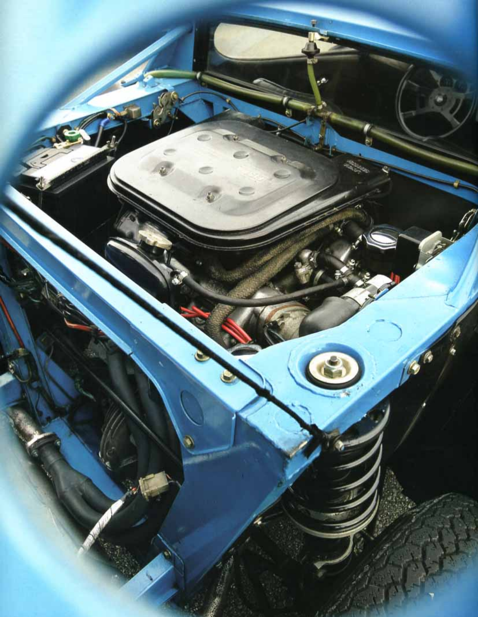
ランチアの代表ウッド・ゴッパードの尽力により、フェラーリから供給されたディーノV6ユニット。9kgから8.1kgに軽量化されたフライホイール、3基のウェーバ-40IDFのキャブレター以外はディーノと共通。
