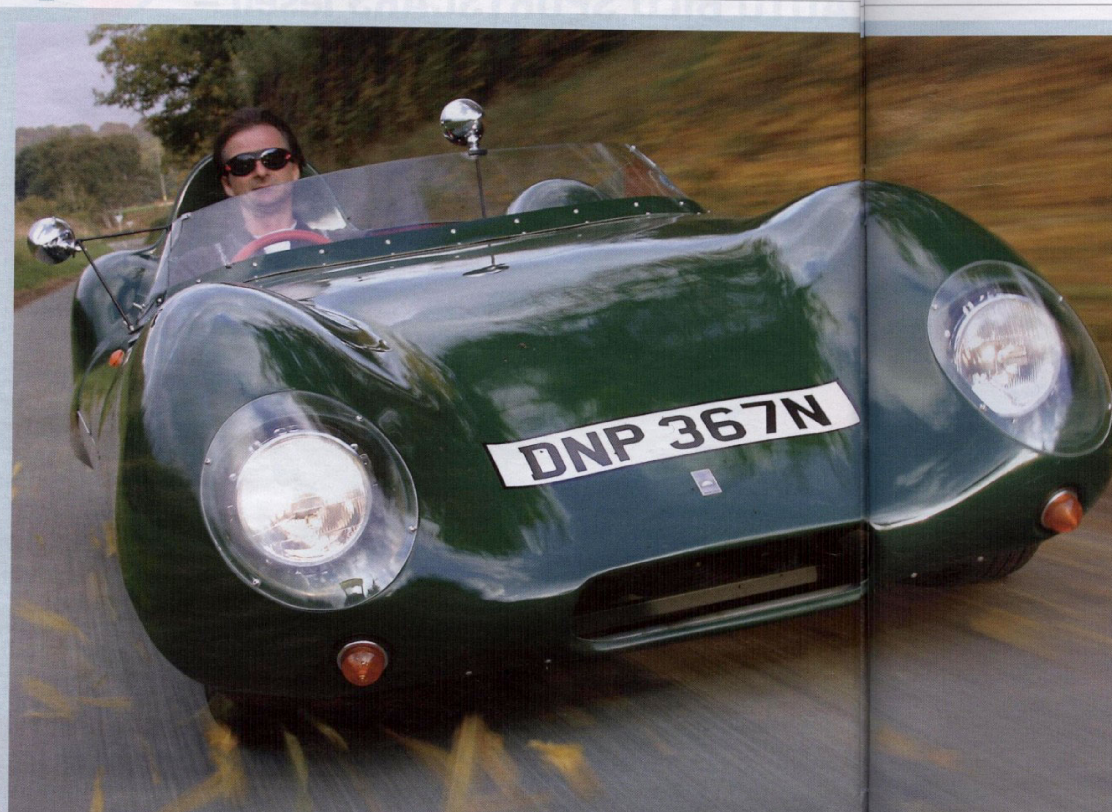
So einfach können Autos sein: Minilite-Räder, große und leichte Glasfaserhauben, im Heck nichts anderes als die sorgfältig geführte Hinterachse
