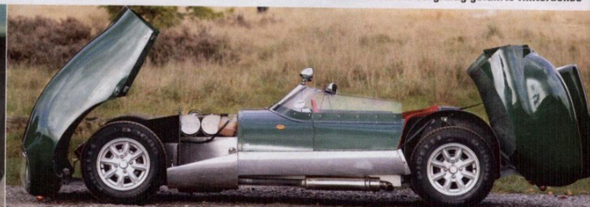
So einfach können Autos sein: Minilite-Räder, große und leichte Glasfaserhauben, im Heck nichts anderes als die sorgfältig geführte Hinterachse
